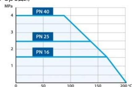
ГРАФИК ЗАВИСИМОСТИ РАБОЧЕГО ДАВЛЕНИЯ И ТЕМПЕРАТУРЫ
